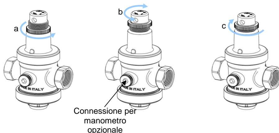
La pressione così impostata verrà mantenuta fintanto che l'impianto è chiuso, al passaggio dell'acqua il riduttore di pressione genererà una perdita di carico che andrà a sottrarsi al valore impostato.
