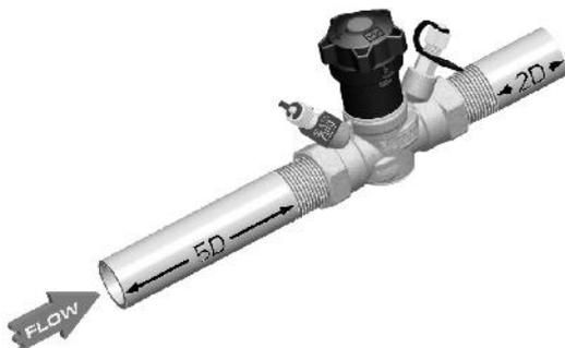
Le valvole VIR serie 9530 hanno estremità filettate femmina (ISO 228/1 per DN15 e DN20, ISO 7/1 Rp oltre) e possono essere corredate di adattatori calotta ogiva opzionali per tubo rame da 15mm (per valvole DN 1/2") o 22mm (per valvole DN 3/4"). NON utilizzare gli adattatori con tubi in acciaio filettati.
