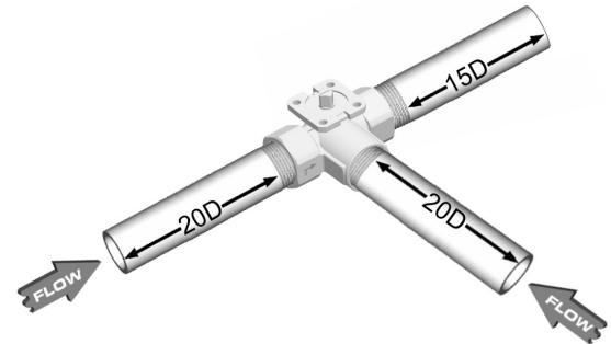
Per evitare forti rumori di flusso si consiglia, ove possibile, di montare le valvole in modo che a monte ci sia un tratto rettilineo di tubo pari ad almeno 20 volte il diametro nominale del tubo e a valle pari ad almeno 15 volte lo stesso diametro.
