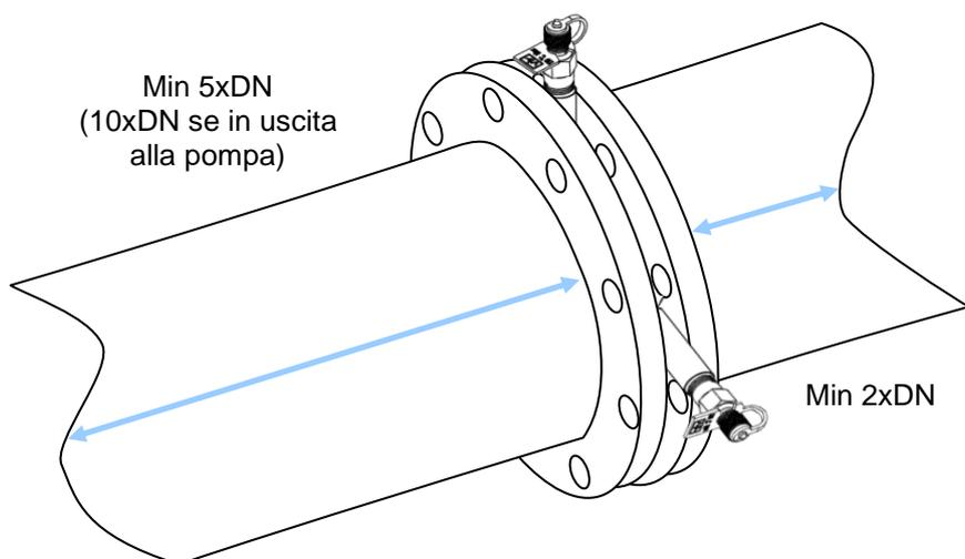
Il misuratore di portata può anche essere installato con valvola di bilanciamento di uguale DN (ad esempio VIR Fig.9565P composta da misuratore di portata Fig.9450 + valvola di bilanciamento Fig.9555P) secondo la configurazione seguente.
