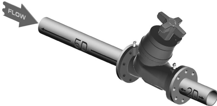
E' importante che la direzione del flusso sia conforme con la freccia presente sul corpo delle valvole. Per ottenere la migliore accuratezza di misurazione della portata si consiglia inoltre di installare le valvole 9555Q:
