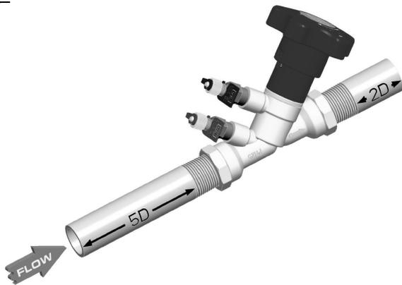
Le valvole VIR serie 9500 hanno estremità filettate femmina ISO 228/1. E' importante che la direzione del flusso sia conforme con la freccia presente sul corpo delle valvole. Per ottenere la migliore accuratezza di misurazione della portata si consiglia inoltre di installare le valvole della serie 9500:
