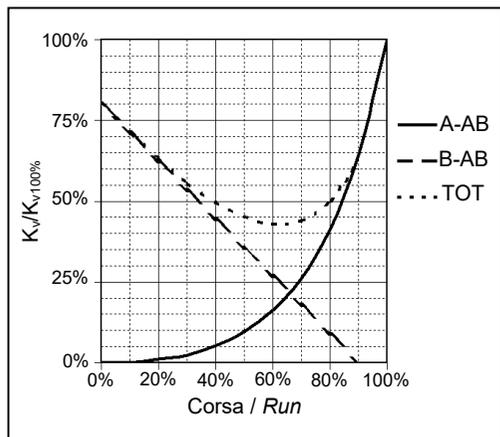
La portata massima sulla via principale in funzione della pressione differenziale applicata alla valvola varia in accordo al diagramma di funzionamento sopra presentato.
