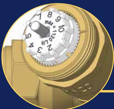
La preregolazione della PICV permette di impostare la portata e mantenerla costante (con l'utilizzo del bilanciamento dinamico) all'interno dell'unità terminale. La pressione differenziale sulla PICV deve rimanere all'interno del suo range di funzionamento e può essere misurata usando il sensore T650, connesso alle prese di pressione della valvola.
